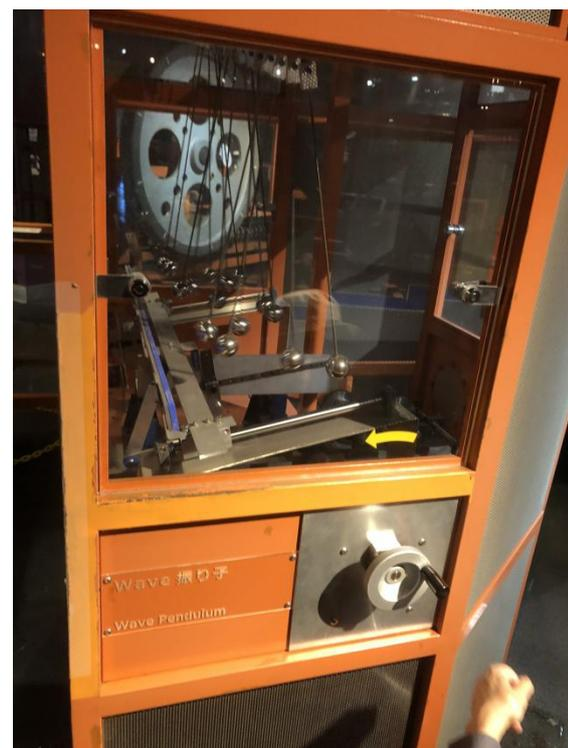
ボールを見つけたら、ペダル、ハンドルで、ギヤ、リンク、クランク、チェーンの作用で上に運ぶとある。
